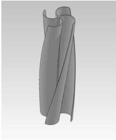
**PROGETTO SIMPLE:** l'obiettivo tecnologico del progetto è la progettazione e la realizzazione di un sistema di generazione microeolico. Settori di impiego: generazione distribuita in ambiente urbano, sia su palificazioni a terra che su edifici. Generazione di bassa potenza in ambiente rurale ed in siti remoti. Storage energetico integrato nella struttura di sostegno in grado di garantire continuità nella fornitura energetica.
