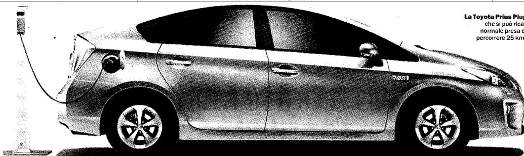
La Toyota Prius Plug-in, il modello ibrido che si può ricaricare anche con una normale presa di corrente in grado di percorrere 25 km in modalità elettrica
